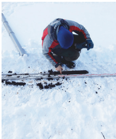
Рис. 107. Изучение керна (пробы грунта) в торфяном буре
