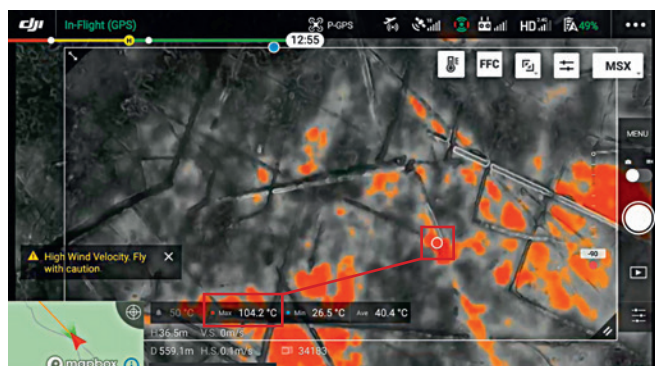
Рис. 36. Тепловизор настроен плохо: кроме очага 104.2 °C (красная точка) видны пятна нагретой земли (большинство красных пятен)
