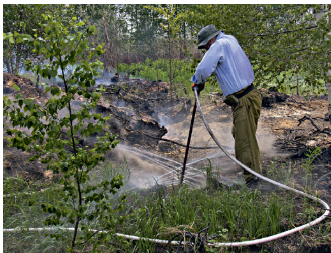
Рис. 48. Использование торфяного ствола ТС-1 на начальной стадии тушения бывшего торфяного штабеля. Впоследствии этот участок будет размыт компактными струями из ручных стволов
