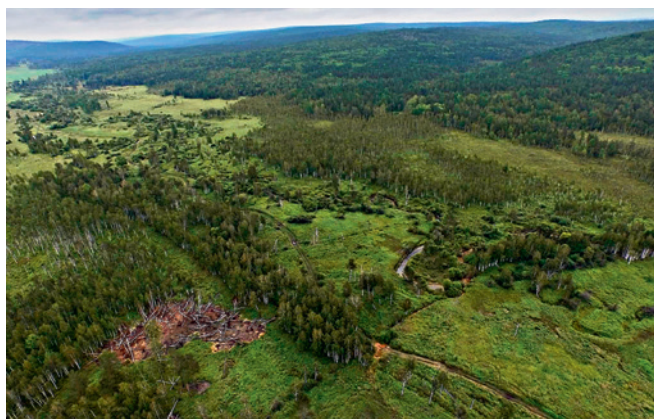
Рис. 72. Поиск действующих очагов тления торфа и мест для забора воды с помощью беспилотного летательного аппарата. Осушенный низинный торфяник. Видны действующие очаги, удобное место для установки АЦ или ПНС-110 на излучине реки. Иркутская область
