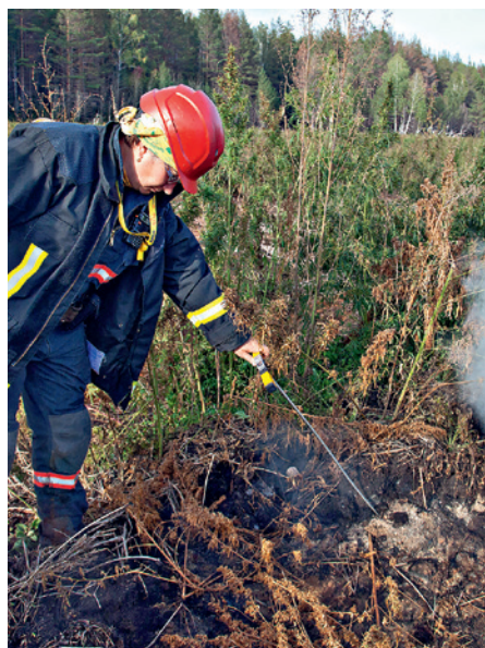
Рис. 63. Определение глубины торфяного очага щупом-термометром
