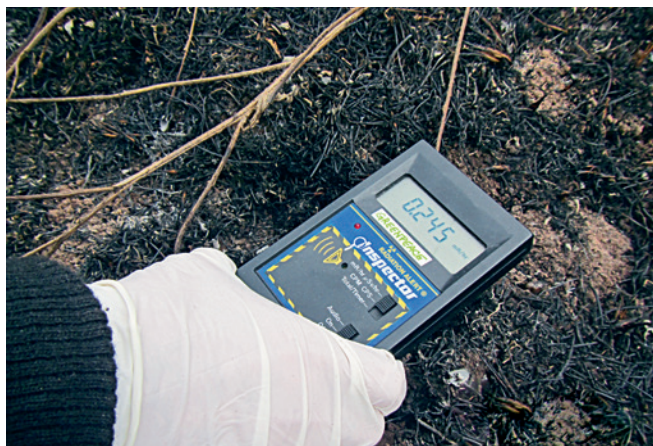
Рис. 97. Применение портативного дозиметра на торфяном пожаре. Брянская область
